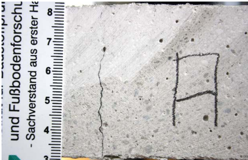
Die Biegezugfestigkeit der sanierten Calciumsulfat-Fließestriche wurde über eine Vier-Punkt-Biegezugprüfung ermittelt.
