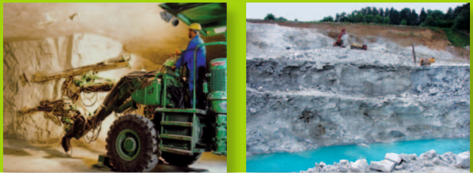
Abb. 5: Abbau von Naturanhydrit im Untertagebau (links) bzw. im Tagebau (rechts)
