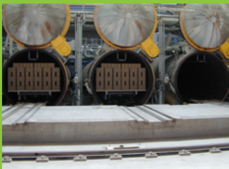
Abb. 7: Autoklaven zur Herstellung von Alpha-Halbhydrat
