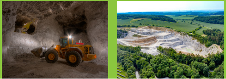
Abb. 5: Abbau von Naturanhydrit im Untertagebau (links) bzw. im Tagebau (rechts)
