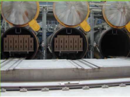
Abb. 7: Autoklaven zur Herstellung von Alpha-Halbhydrat
